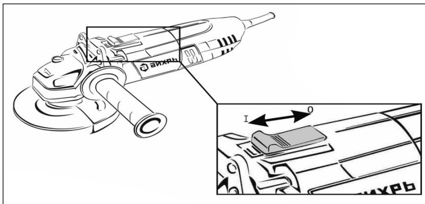
Рис. 7. Клавиша включения моделей с рукояткой «Компакт»
